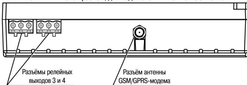
Рисунок 3.2 – Вид на верхнюю поверхность КСОД
